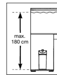
Respectați distanța de 180 cm max. între suprafața apei și fundul filtrului pentru a obține o siguranță optimă de funcționare.
