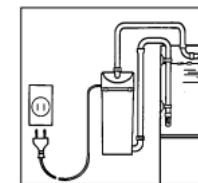
**Se si usa una presa distributrice, la sistemazione deve avvenire al di sopra del collegamento alla rete del filtro.**
