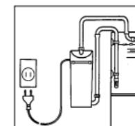
**Bij gebruik van een losse contactdoos dient deze boven de filter-aansluitkabel geplaatst te worden.**
